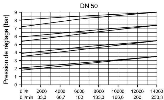
Les caractéristiques dans les diagrammes présentent la chute de la pression de réglage de 0 au débit max. autorisé.
