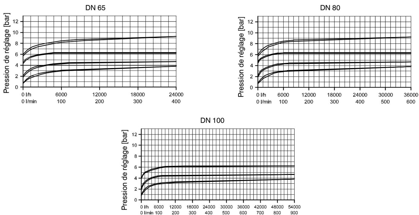
Les caractéristiques dans les diagrammes présentent la chute de la pression de réglage de 0 au débit max. autorisé. La courbe supérieure présente le déroulement de la pression d'ouverture, la courbe inférieure le déroulement de la pression de fermeture. Toutes les caractéristiques se réfèrent à de l'eau à 20 °C.
