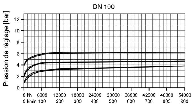
Les caractéristiques dans les diagrammes présentent la chute de la pression de réglage de 0 au débit max. autorisé. La courbe supérieure présente le déroulement de la pression d'ouverture, la courbe inférieure le déroulement de la pression de fermeture. Toutes les caractéristiques se réfèrent à de l'eau à 20 °C.
