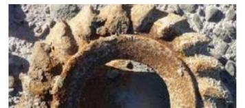
Après 8 jours les ailettes d'une roue classique sont détruites à l'ouïe, la surface extérieure de la roue est sévèrement érodée
