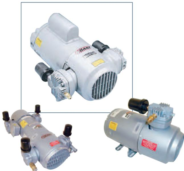
Les compresseurs à piston sec (non lubrifié) sont conçus pour assurer des performances maximales tout au long de leur durée de vie. En effet, lorsque l'épaisseur des segments diminue, un système unique de joint inox à recouvrement se détend et permet d'éviter les fuites éventuelles devant ou derrière les segments. De plus, ces compresseurs sont construits pour résister à des conditions d'utilisation difficiles, grâce à l'utilisation de pièces internes spécialement traitées contre la corrosion.
