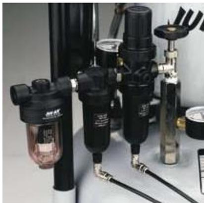
*Filtres montés sur un compresseur*
