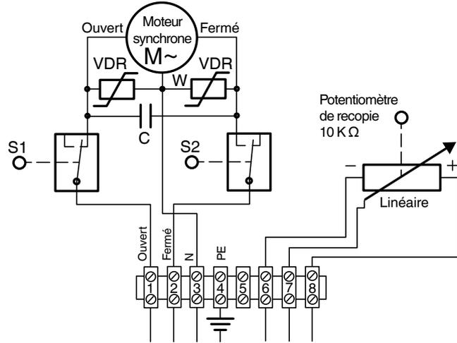
**Module de fonction AE commande OUVERT / FERMÉ avec 2 indications de fin de course supplémentaires et connecteur Hirschmann N 6 R AM2 (version : 6027)**
