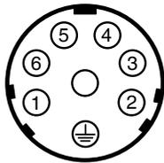
**Module de fonction AP commande OUVERT / FERMÉ avec sortie potentiomètre et connecteur Hirschmann N 6 R AM2 (version : 6027)**
