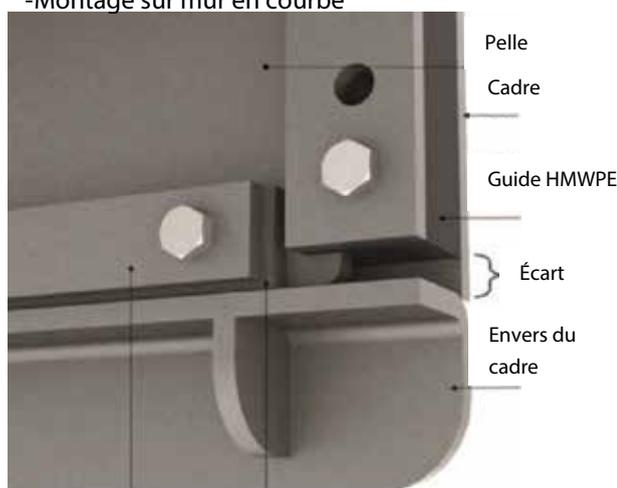
Dispositif de retenue Joint inférieur
